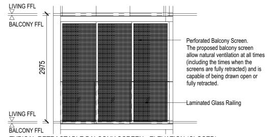
TYPICAL RETRACTABLE BALCONY SCREEN - ELEVATION (CLOSED)
